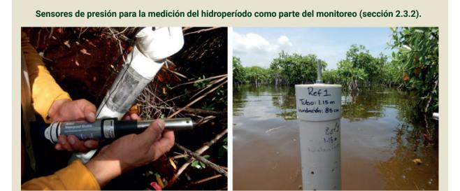
Figura 2.26 — Monitoreo del hidroperíodo durante la restauración.
