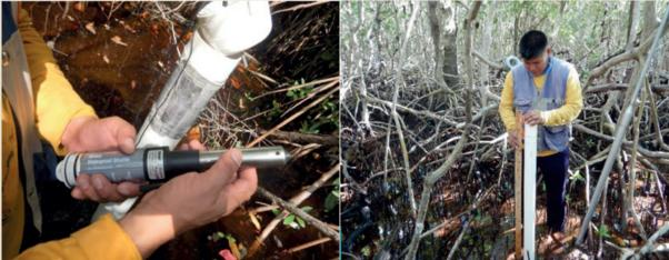
Sensor automático de presión marca HOBO
