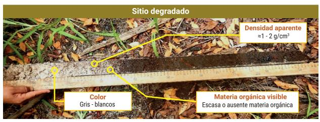
Figura 2.12 — Comparación de variables "proxy" como color, densidad aparente y materia orgánica visible en los núcleos de sedimento de un sitio conservado de referencia y uno degradado.
