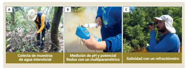
**Figura 2.27** – Colecta de muestras de agua intersticial (A); medición de pH y potencial Redox con un multiparamétrico (B), salinidad con un refractómetro (C).
