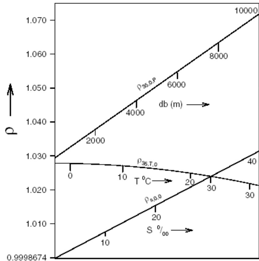
Fig. I.3. Variación de la densidad ( $\rho$ ) del agua de mar en función de los valores de salinidad ( $S$ ‰), temperatura ( $T$ °C) y presión ( $db$ ) encontrados en el mar.
