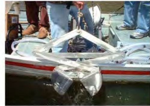
Figura 4 - Draga tipo Petersen, utilizada para coleta de amostra de sedimento.
